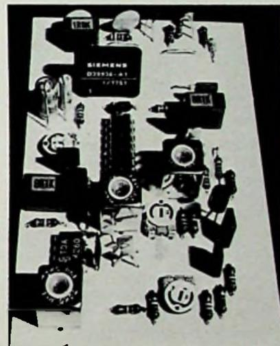
Oberflächenwellen-Filter B39936 (oben links) auf einer Platine (Siemens)
